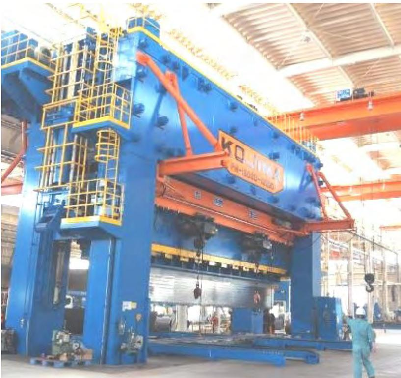
▲富田製作所古河工場の1万6000トンの油圧プレス機
